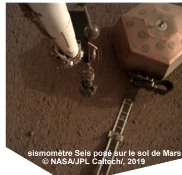
sismomètre Seis posé sur le sol de Mars
